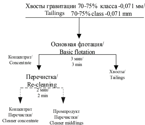
Схема флотационных опытов, выполненных на пробе руды / Flowsheet of the flotation experiments on the ore sample
